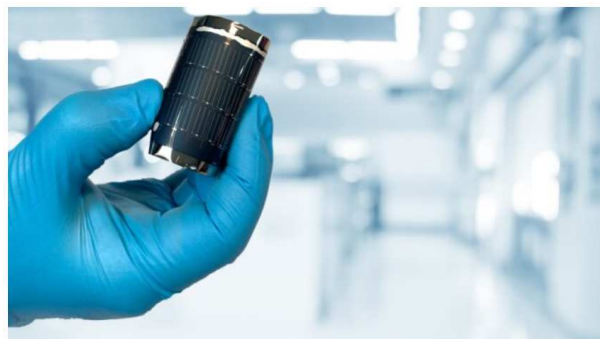
Die flexible Solarzelle auf Polymerfolie. Bild: empa.
