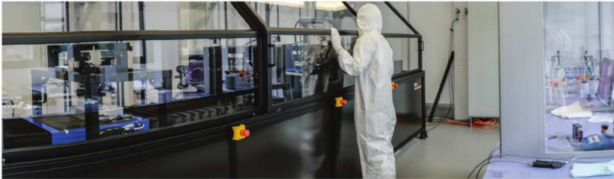
An der Empa in Dübendorf stellen Wissenschaftler mit dieser Anlage im Schlitzdüsen-Verfahren Perowskit-Solarzellen in der Grösse von 10 x 10 cm her. Im Zuge des aktuell laufenden Forschungsprojekts UPero soll das Herstellungsverfahren auf eine Zellgrösse von 30 x 30 cm hochskaliert werden. Foto: Empa
